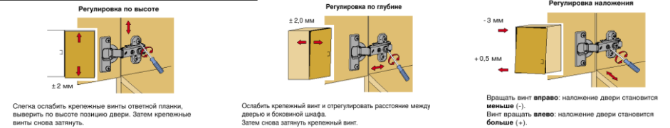
Рис.4 Схема установки подвески
