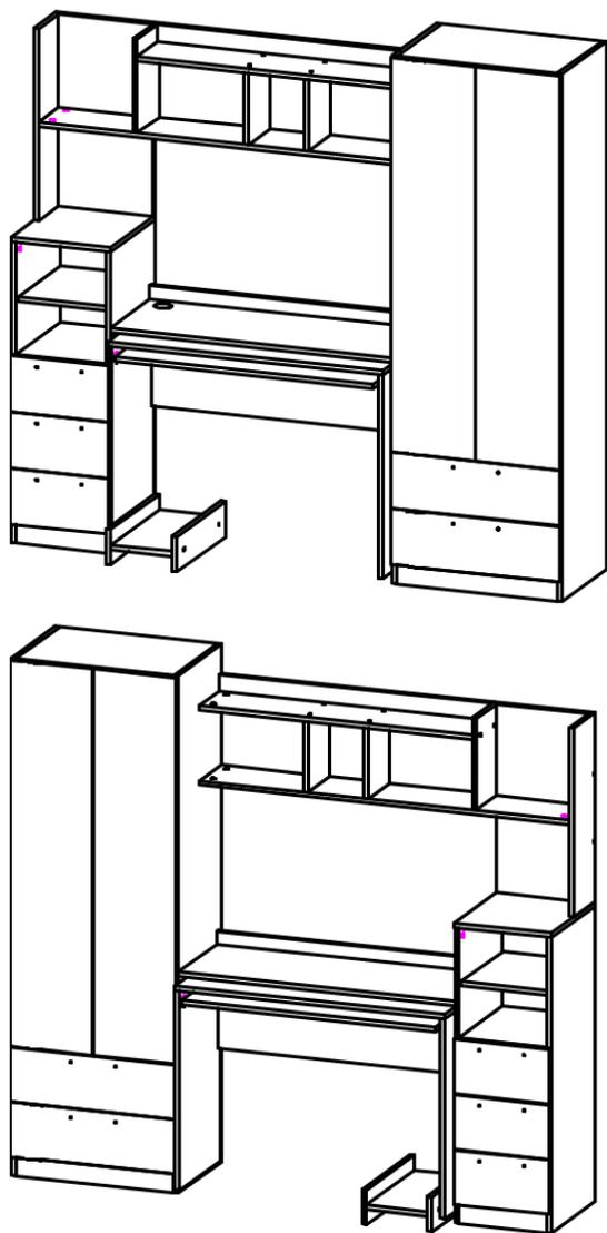
Рис.5 Схема сборки на правую и левую стороны
