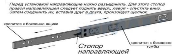
Рис.2 Схема установки шариковых направляющих
